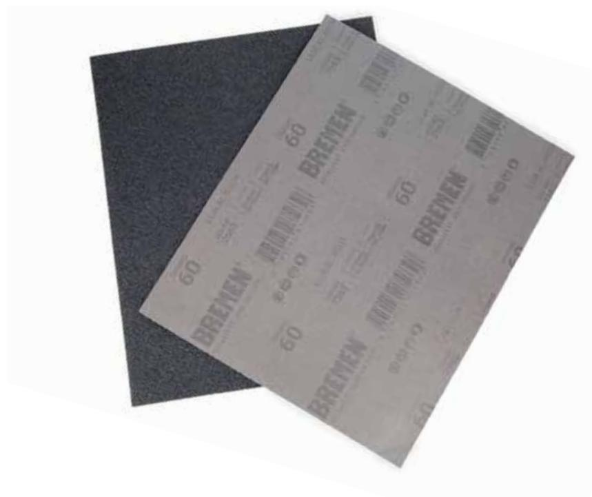
Las lijas al agua se utilizan principalmente para aquellas aplicaciones donde, dadas las características del material a trabajar, pueda darse un exceso de temperatura por fricción, que podrá ser contrarrestado por la acción del lubricante aplicado: agua. De esta manera se evita perjudicar la pieza trabajada y se favorece la eliminación del material ya lijado, evitando el empaste de la lija.
