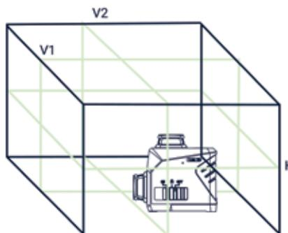
Posee 3 planos autonivelantes (+ - 3°) que ofrecen la posibilidad de nivelar o realizar verificaciones sobre superficies horizontales y verticales en simultáneo. Esto redundará en una disminución de los tiempos de operación.
