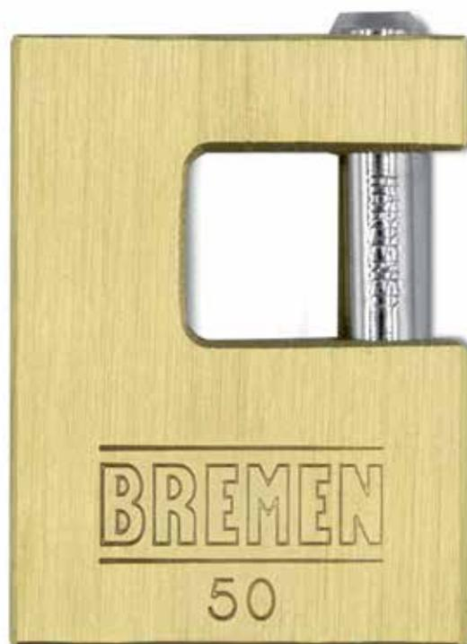
Gracias a su morfología y sistema de cierre, con traba horizontal de giro libre cementada y templada, el perno queda levemente expuesto. Esto dificulta que pueda ser vulnerado con un cortaperno u otro elemento.
